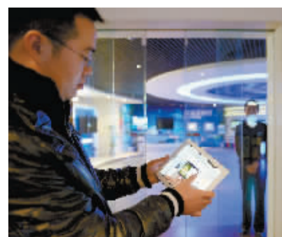
通过门外摄像头发送到Pad上来访客头像,可控制门禁开关
